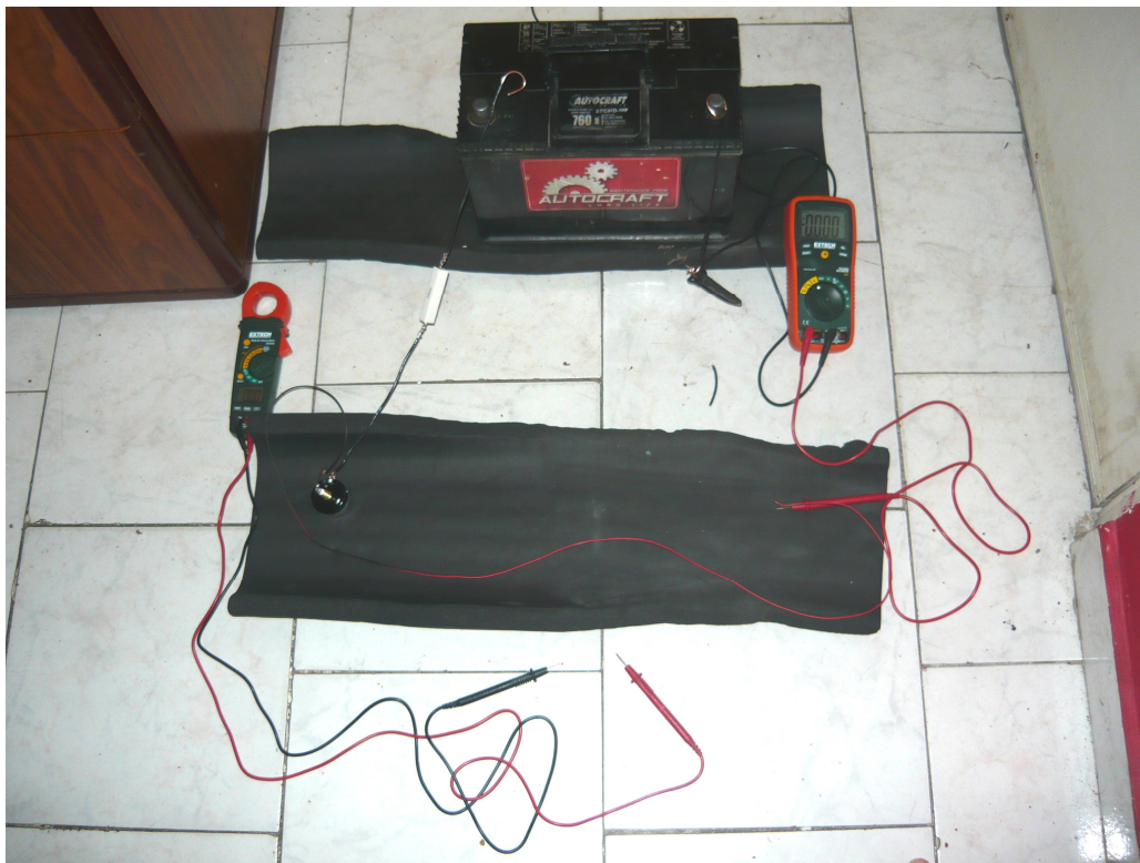
Imagen 7.3.4. Circuito de pruebas listo para entrar en funcionamiento solo al conectar el terminal positivo (el izquierdo) de la fuente de energía. El cable a probar está sobre el aislante negro inferior; y la fuente sobre otro aislante negro idéntico en la parte superior de la imagen.
