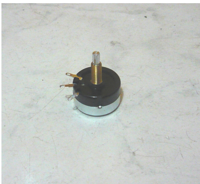
Imagen 7.1.5.1. Potenciómetro de alta potencia, para realizar ajustes finos en la ampacidad del circuito.
