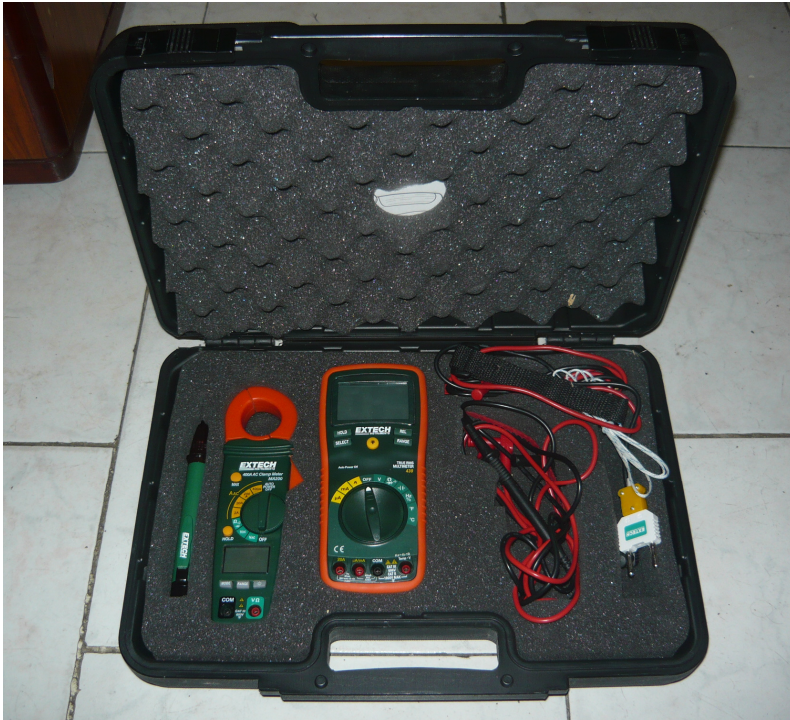
Imagen 7.1.3.1. Kid de mediciones eléctricas industriales de alta precisión de EXTECH INSTRUMENTS, modelo KT430-IR.
