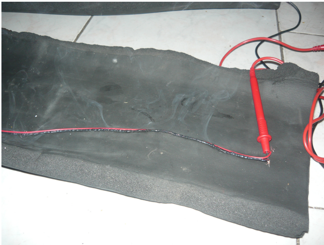
Imagen 8.3.6. Cable 24 AWG en el momento que derrite su aislante a 150°C con aproximadamente 13 amperios de corriente.
