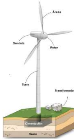
Figura 3. Elementos principales de un aerogenerador
