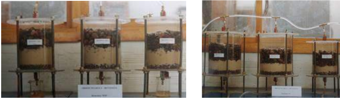
Figura 4. Batería de Permeámetros Grava-Bentonita para las ambas bentonitas IIM y R.
