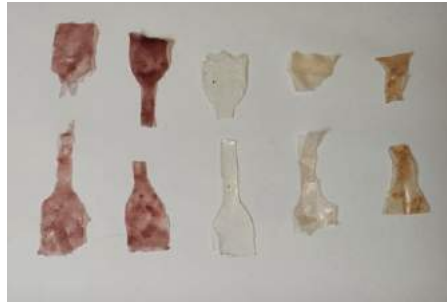
Figura 3. Ruptura de probeta. De izquierda a derecha, 2 de ñampí, yuca, oteo y ñame diamante.
