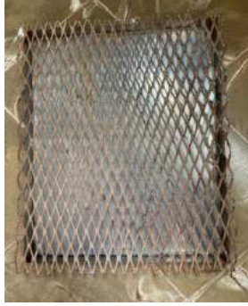
Figura 1. Molde con sistema de rejilla implementado para inmovilizar la superficie de la mezcla.
