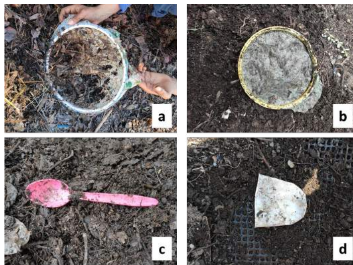
Figura 4. a) Bolsa degradada después de 4 días del inicio la prueba, b-d) APUSU no degradados después de 141 días
