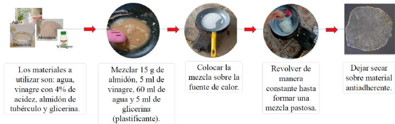
Figura 1. Elaboración del bioplástico de tubérculos panameños
